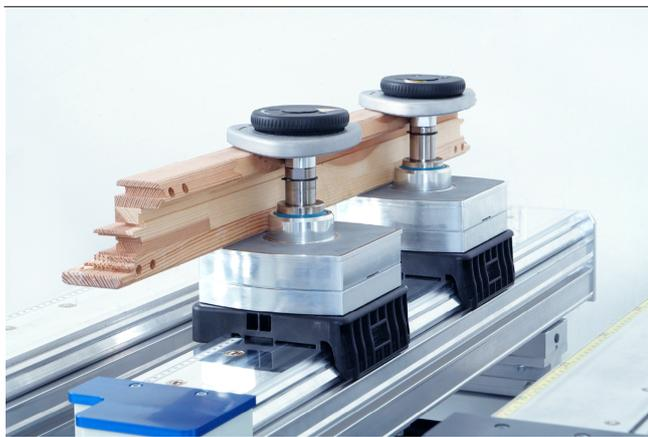
Механический зажим VCMC-S4-QUICK при зажатии деталей рамы
