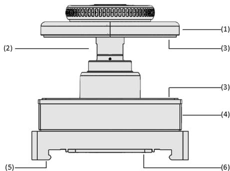
Конструкция системы Механический зажим VCMC-S4-QUICK
